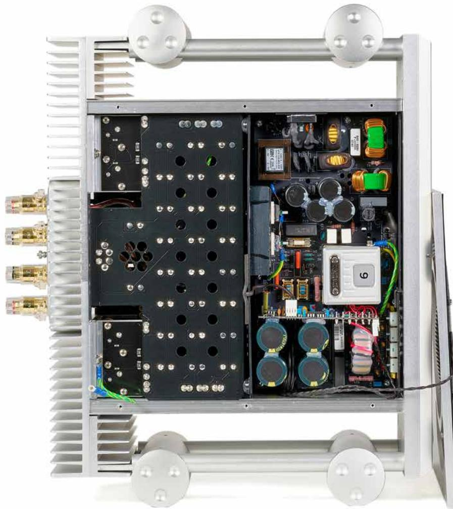
Schwergewichtige Bauteile gibt's natürlich auch in der Endstufe Ultima 6 Stereo. Die leistet 180 Watt an acht Ohm und besitzt ebenfalls ein gekapseltes HF-Schaltnetzteil. Man beachte die pfiffige Fußkonstruktion. Die eigentlichen „Säulen der Ruhe“ sind an Auslegern befestigt. Stapelt man mehrere Ultimas (was gemäß Herstellerkonzept erlaubt ist) beeinflusst die obere Komponente nicht die Schaltkreise der darunterliegenden – und umgekehrt.
