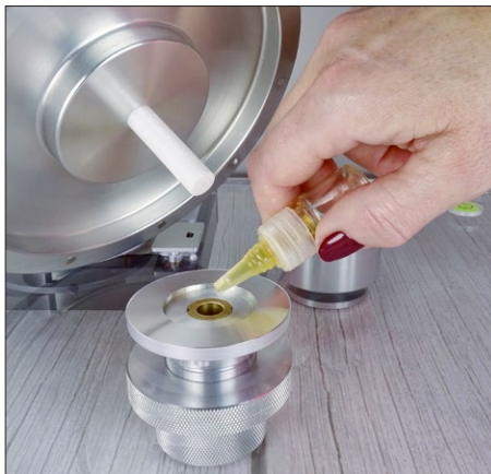
Die Achse des Subtellers besteht aus Keramik. Vor dem Betrieb muss das Lager geölt werden.
