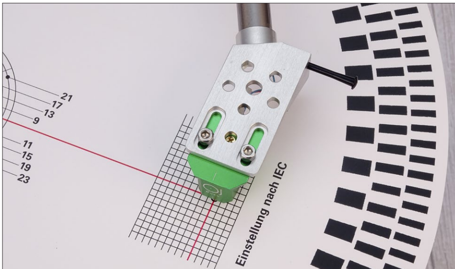
Wer Takumis Kuro-MC verwendet, bekommt Hilfe bei der Justage: Der Abtaster ist dann korrekt eingebaut, wenn dessen obere Fixierschraube zentral im vordersten Loch der Headshell erscheint.
