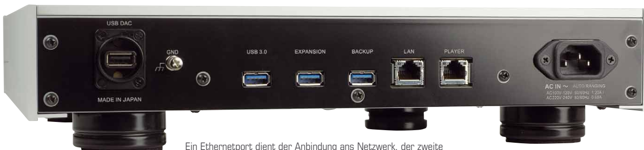
Ein Ethernetport dient der Anbindung ans Netzwerk, der zweite filtert die Datenströme für angeschlossene Streamer
