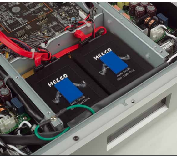
Versorgt durch ein eigenes Netzteil, arbeiten hier zwei, speziell für Audioanwendungen optimierte SSDs
