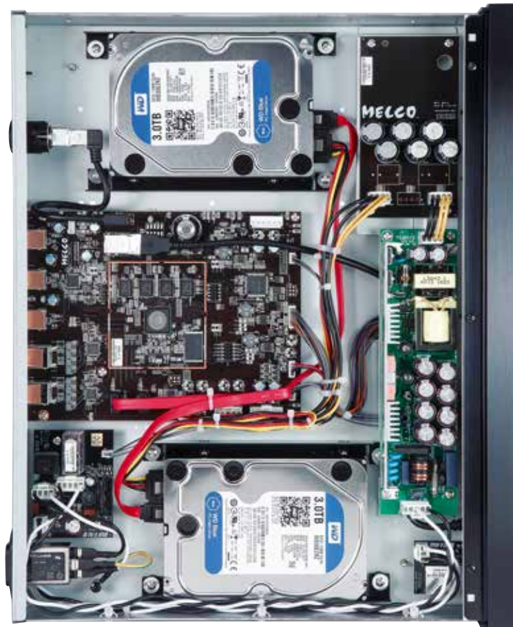
◀ Jede Baugruppe auf einer eigenen Platine, großzügige Stromaufbereitung sowie zwei Festplatten, die sich zu sechs Terabyte Gesamtspeicher ergänzen. Das Mainboard im Zentrum lässt Melco übrigens eigens für seine Server fertigen.
