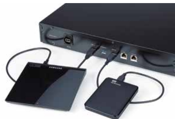
▼ Der N1A/2 kann via USB um Peripherie erweitert werden. Über einen USB-Hub kann man die Zahl der Buchsen vergrößern.
