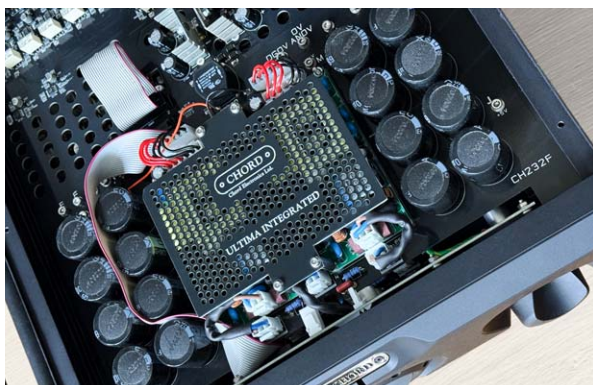
Sämtliche Eingänge des Chord Ultima Integrated weisen Schutzmaßnahmen gegenüber HF-Einflüssen auf, die Eingangsumschaltung vollzieht sich über ein Relais
