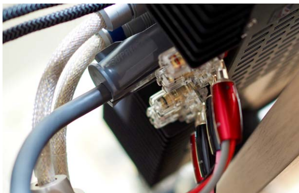
Will man Lautsprecherkabel mit Spades nutzen, muss man darauf achten, dass einem nicht die Stellfläche des Chord-Verstärkers in die Quere kommt
