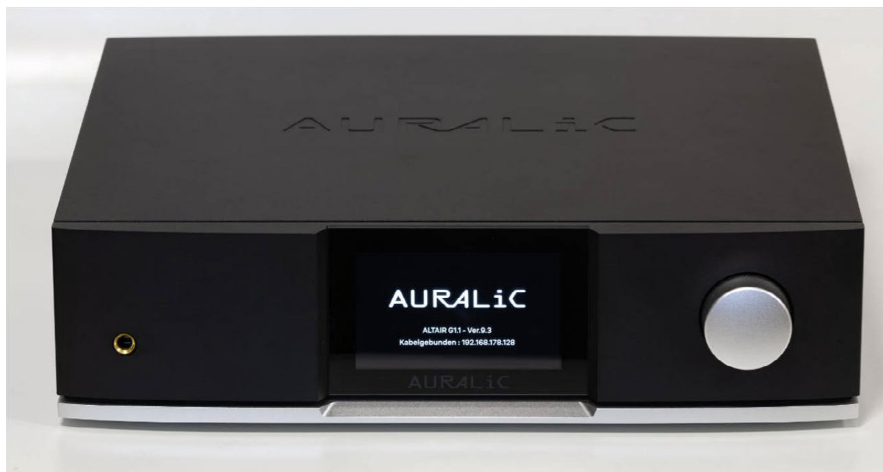
Die gesamte Oberschale des Altair ist aus einem massiven Block Alu gefräst. Die silbern abgesetzte Bodenplatte bietet einen farblichen Akzent und lässt das Gerät schlanker erscheinen (Foto: F. Borowski)
